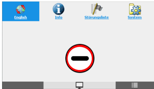
Fig. 7-2: Unsachgemäßer Konfigurationsmodus mit stark eingeschränktem Funktionsumfang
