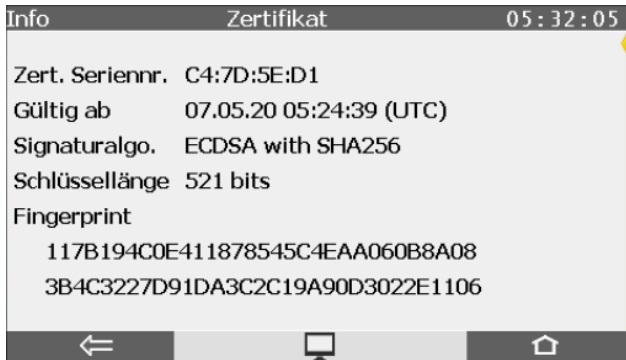
Fig. 7-5: Anzeige Zertifikat mit Zertifikatsinformation - Beispiel
