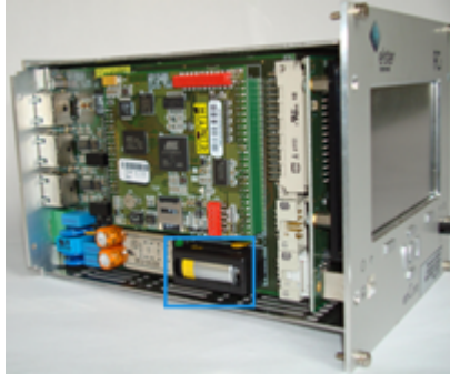
Fig. 8-2: linke Seitenwand entfernen
