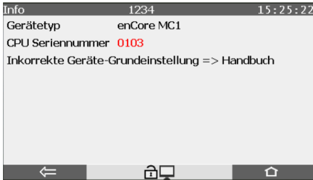
Fig. 11-4: Im Beispiel passt die CPU-Seriennummer nicht zu der Geräte-Grundeinstellung
